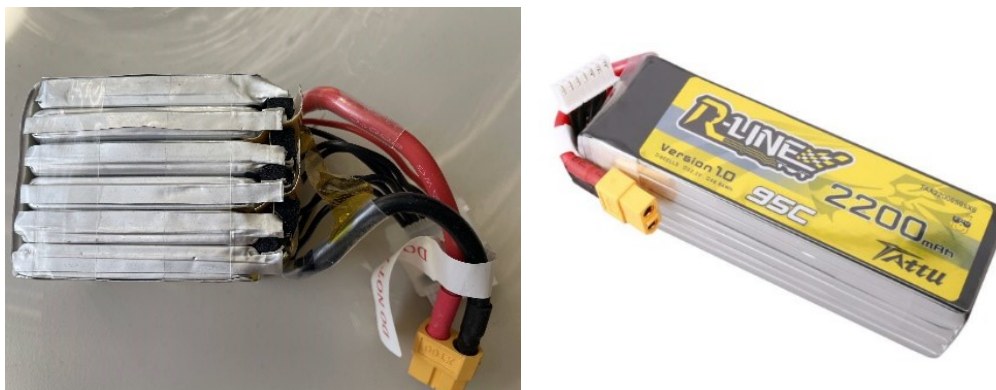
Obr. 1: Jednoduchá baterie 6S FPV dronu (neobsahuje BMS).
